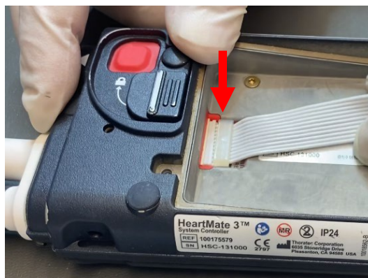
Figura 1: Conectarea cablului-panglică al bateriei de rezervă
